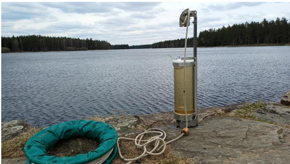
Figur 8. Limnoshämtare för vattenprovtagning vid 40-Fågelforsdammen (Foto: Sweco Sverige AB, 2026)
